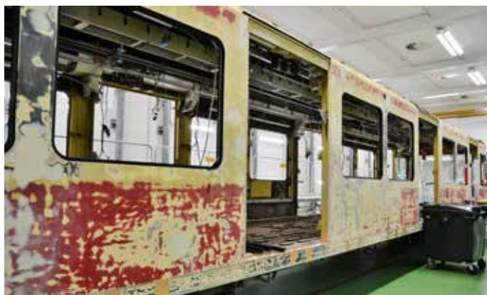
Nach dem Schleifen: bereit für die neue Lackierung. Aus den Viertelzügen der Jahre 1997 bis 2004 wird nahezu alles ausgebaut.
