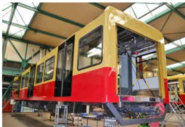
Ein neu lackierter Wagenkasten, in dem noch die Sitze fehlen. Markant sind die neuen Türen in schwarz.
